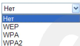
Если выбрано **NONE**, то камера подключается к незащищенной сети без использования шифрования.
