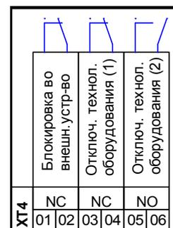
На схеме показано состояние контактов формирования извещений при отключенном приводе.
